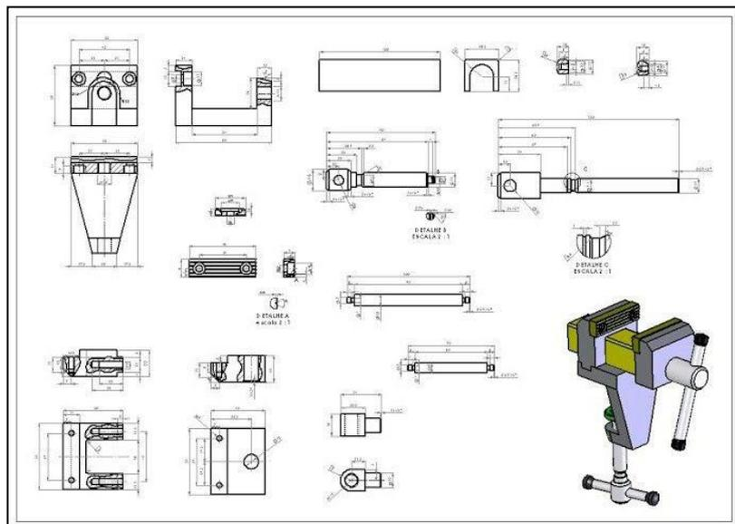
En el plano de conjunto **se deben dibujar las vistas necesarias**. Para ver las piezas interiores **se deben realizar los cortes necesarios**. Puesto que lo que importa es ver la distribución de las piezas, se pueden combinar distintos cortes en la misma vista.
