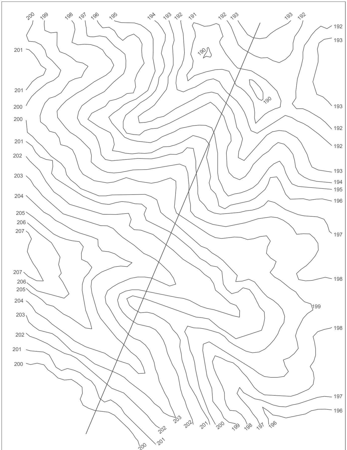
Dada la representación de un terreno y de un camino horizontal de cota 200 m. determinar las áreas de desmonte y terraplén, siendo:
